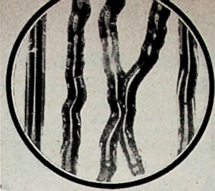
Fig. 78 - Overmodulatie; oversnijden der groeven
