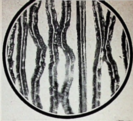
Fig. 75 - Het gevolg van te geringe groefspatie: oversnijding
